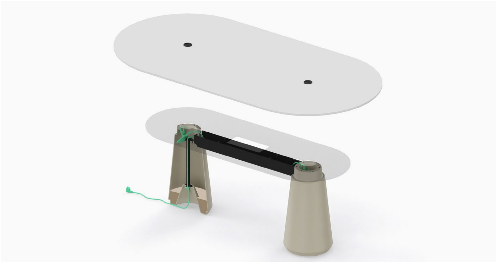
Gestión eléctrica integrada compuesta por una columna electrificada y una canal de electrificación que conecta las dos columnas. Una de las dos columnas está electrificada con un tubo interior fabricado en acero con un diámetro de 40 mm y atornillado a la parte inferior de la columna. La canal de electrificación está fabricada en chapa de acero plegada con un espesor de 3 mm.
